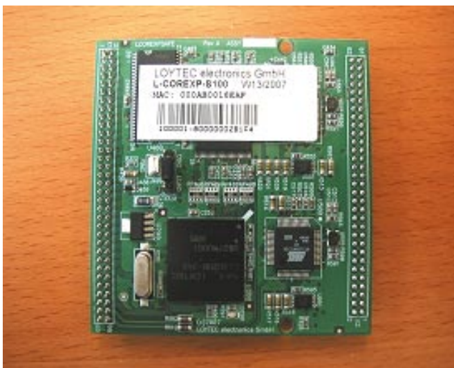
Abb. 3: SAFETYLON Kernmodul basierend auf dem LC3020 Chip (Lisa) von Loytec
